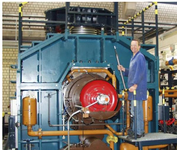
Die Spalthöhen- und Drucksensoren befinden sich in der Welle. Die hochauflösende Erfassung von Schmierfilmdicke und -druck über dem Umfang und der Lagerbreite erfolgt durch axiale Verschiebung der Welle während der Messung. Dabei wird die Messwertübertragung durch mitrotierende Verstärker und Schleifringübertrager realisiert.
